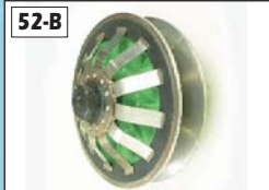
52-B K letterpress / Diecutter #KS.100.048 F φ 265mm
